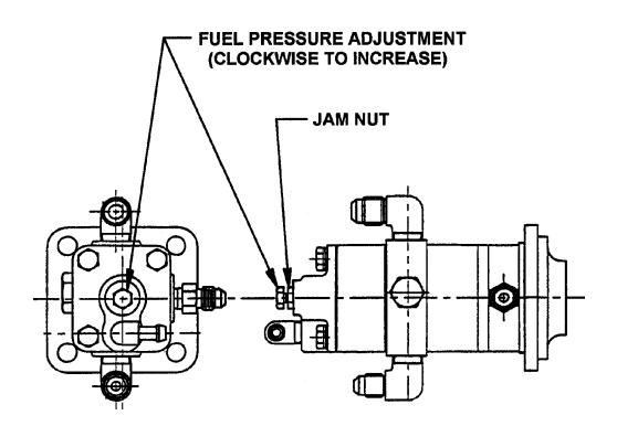
FIGURE 23-2. FUEL PUMP ADJUSTMENT
