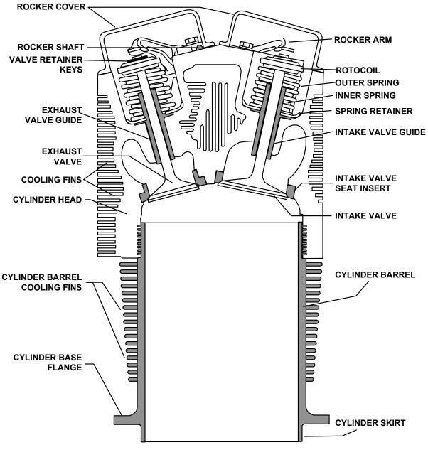
FIGURE 20-3. CYLINDER ASSEMBLY DESCRIPTION
