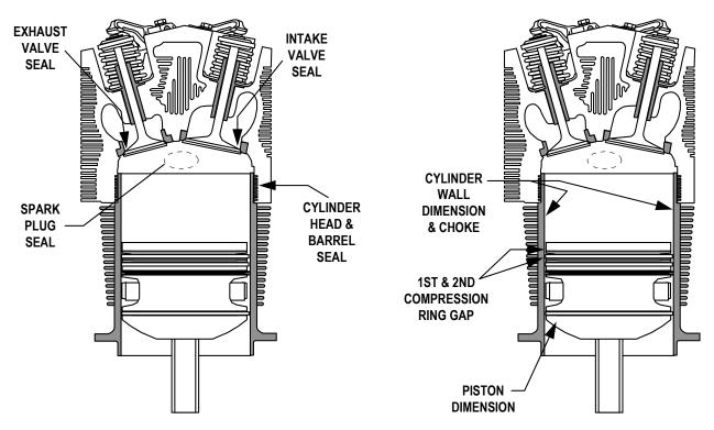
FIGURE 20-8. STATIC SEAL
