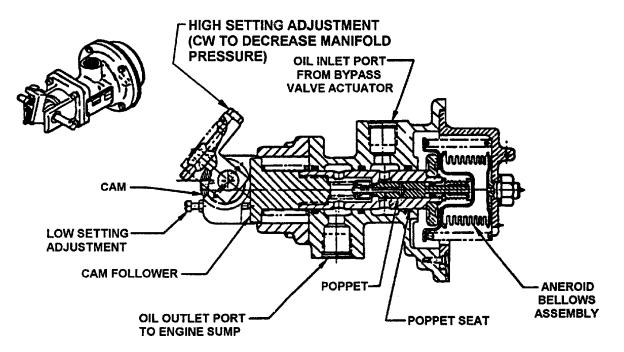
FIGURE 11-5. VARIABLE ABSOULUTE PRESSURE CONTROLLER
