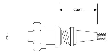
FIGURE 12-9. COATING INSULATING SLEEVE
