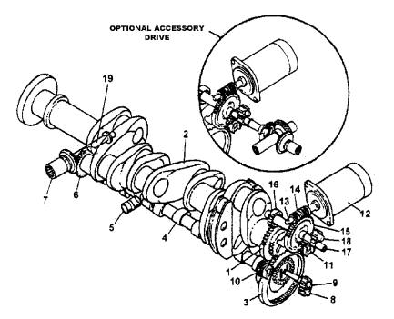
FIGURE 22-1. ENGINE DRIVE TRAIN DESCRIPTION
