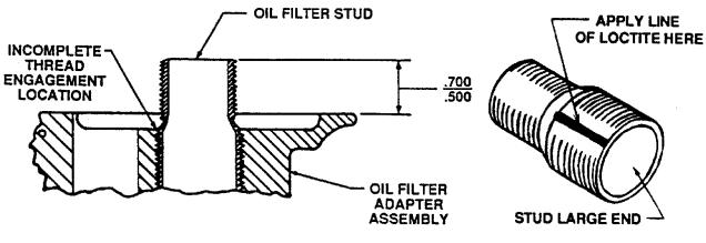
FIGURE 19-7. OIL FILTER ADAPTER STUD INSPECTION
