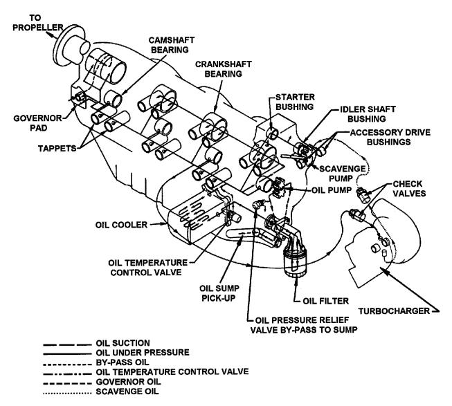
FIGURE 19-1 LUBRICATION SYSTEM SCHEMATIC
